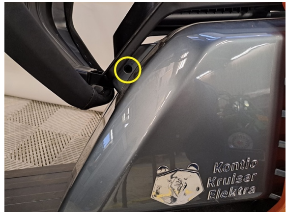
Irrota vasenta kylkipaneelia pitävä kiinnitysruuvi. (ristipäämeisseli ph2).
